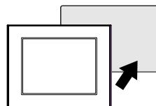
**NOTE:** Ce produit est équipé d'un dispositif anti-chute situé sur le dessus afin d'éviter qu'il ne tombe. Insérez la partie inférieure du produit dans l'ouverture du panneau, puis insérez la partie supérieure tout en appuyant sur le bouton de déverrouillage.
