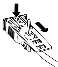
Si vous utilisez le type de montage sur écran et que les deux ports USB 1 et 2 sont équipés de câbles USB avec pinces, retirez d'abord le câble du port USB 1.
