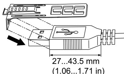
2. Alignez l'attache à l'enveloppe du connecteur du câble USB. Ajustez la position des trous sur lesquels l'attache est fixée. Afin d'assurer la stabilité, sélectionnez la position de trou-attache la plus proche à la base de l'enveloppe du connecteur.
