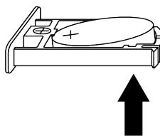
6. Placez la nouvelle batterie dans le plateau selon les marquages de polarité indiqués dans le compartiment et sur la batterie.
