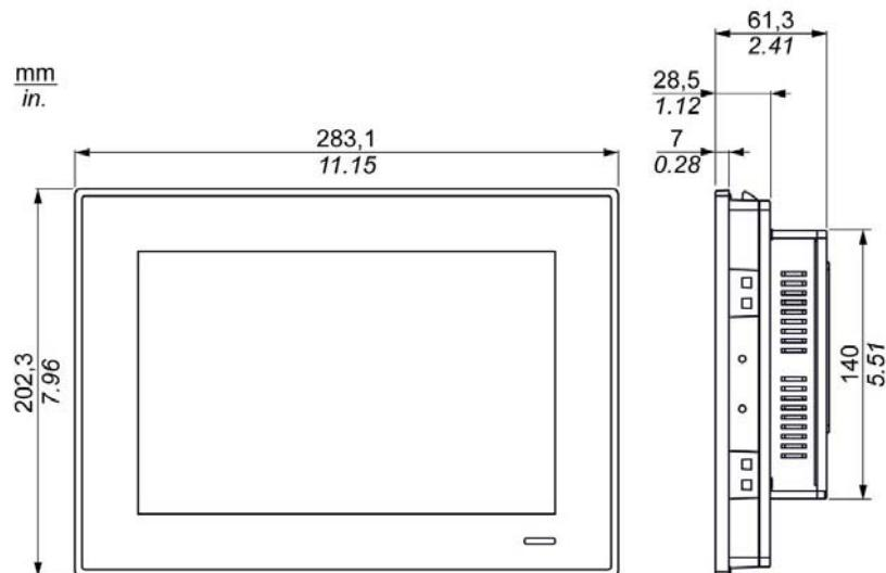
下図にAC電源モジュール(PFXZPSPUAC2)と拡張キット(PFXZPSADSSD2)のある場合の寸法を示します。
