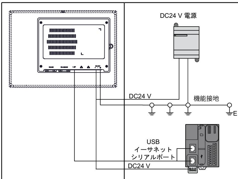
**注記:** AC 電源を使用する場合は、AC 電源モジュールを使用してください。
