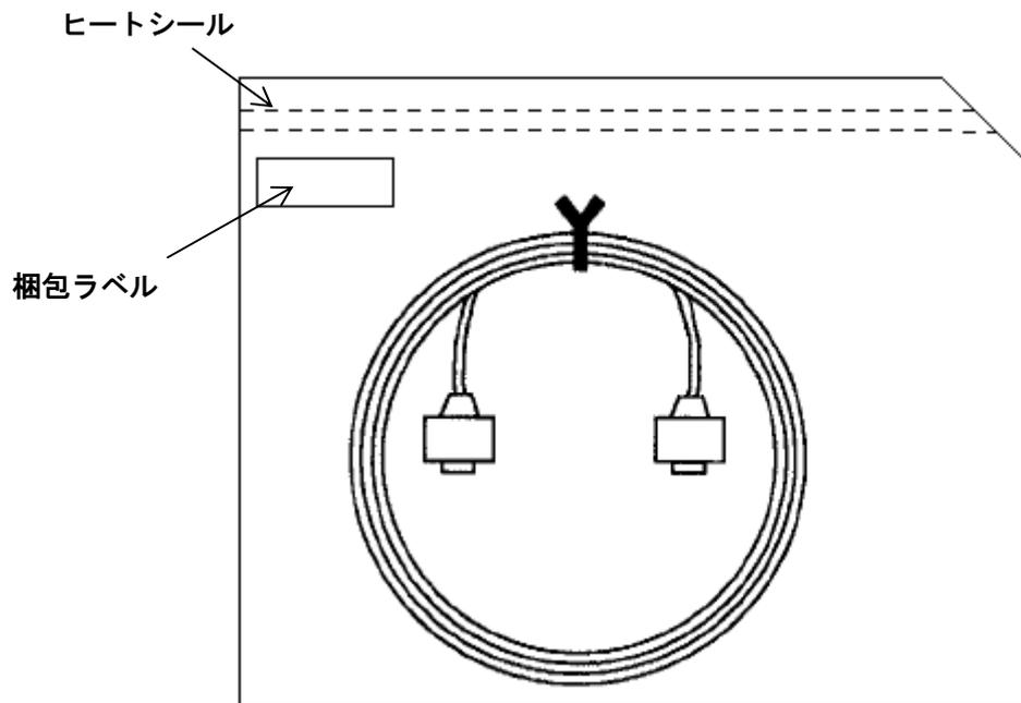
上図のようにビニル袋はヒートシールで封をし、空気穴として角をカットしています。
