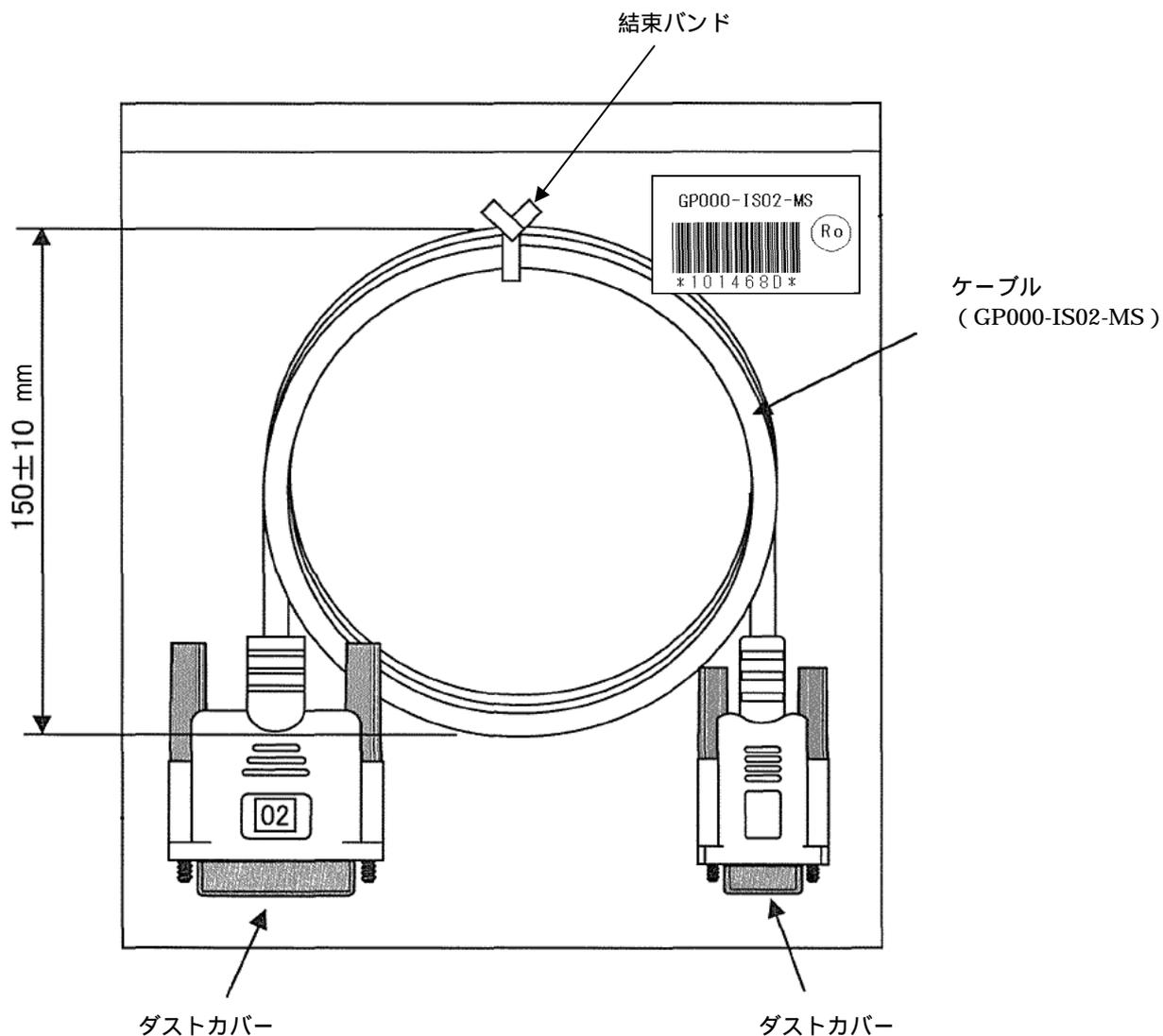
上図のように、ケーブル(GP000-IS02-MS)をビニル袋に入れ、シーラー処理にて封止しています。
