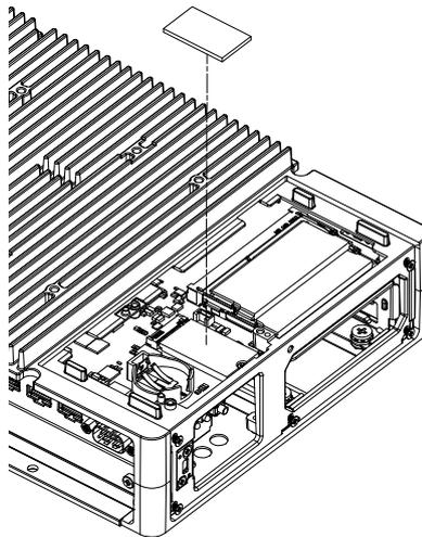
9. ヒートシンクを置き、ネジで取り付けます。
