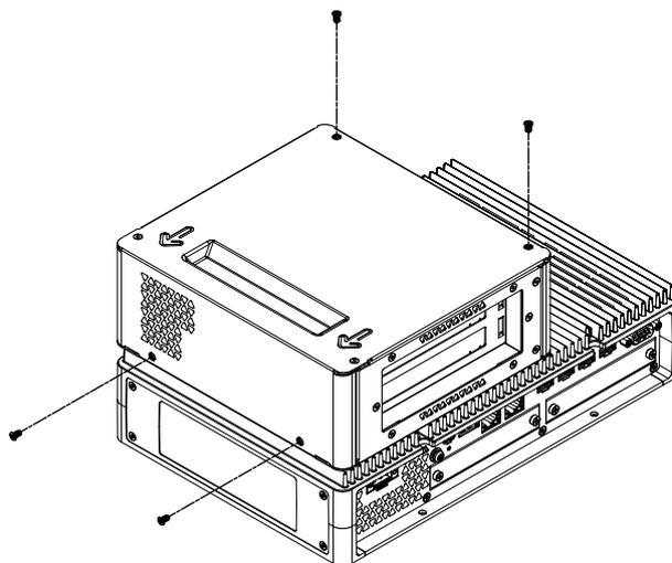
4. カバー上部の矢印の方向にスライドさせて取り外します。
