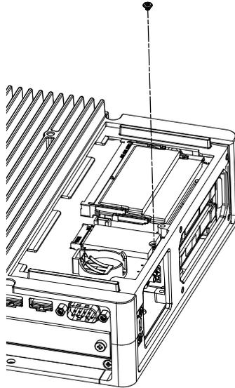
8. ヒートシンクパッド (上用) の貼り付け面側の保護フィルムをはがし、M.2 SSD カードに置きます。ヒートシンクパッド表面側の保護フィルムも剥がします。アドバンストボックスにファンキットを取り付けてご使用になる場合は、この手順は不要です。
