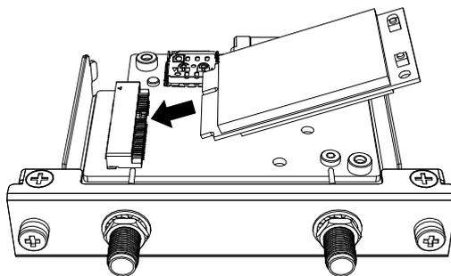
3. 4G mini PCIe カードを上から押し込み手順 1 で外したネジで固定します。
