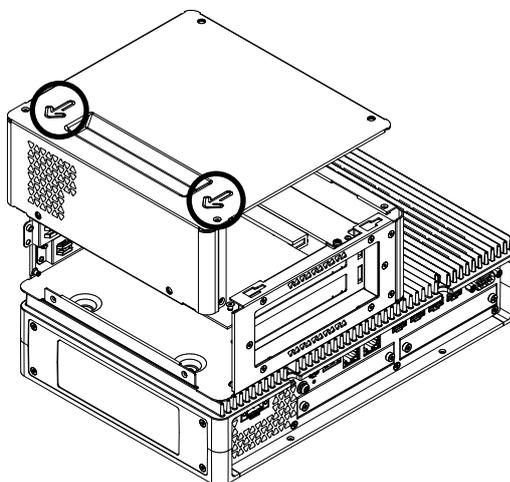
5. インターフェイスカバーのネジを外し、カバーを取り外します。
