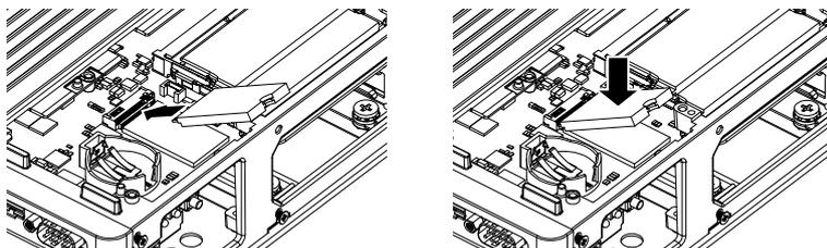
7. 手順 5 で取り外したネジで M.2 SSD カードを固定します。
