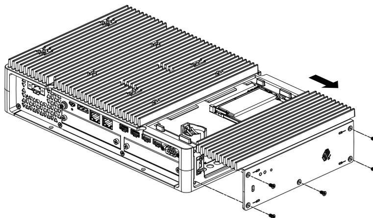
4. ヒートシンクパッド (下用) の貼り付け面側の保護フィルムをはがし、M.2 SSD カードの取り付け位置に置きます。ヒートシンクパッド表面側の保護フィルムも剥がします。アドバンストボックスにファンキットを取り付けてご使用になる場合は、この手順は不要です。
