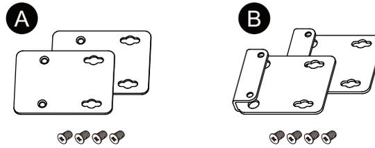
2. 本体に取り付けられているネジを外し (4 か所)、そのネジでブックマウントアダプターを本体に取り付けます。本体上面に取り付ける場合は、B のブックマウントアダプターの突起面を本体側に向けて取り付けます。
