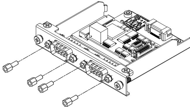
2. カートリッジからインターフェイスコネクタを取り外し、基板に接続されているケーブルも外します。
