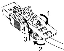
4. 手順 3 の USB ケーブルを、クリップのグリップを押したまま、USB ホストインターフェイスにしっかり奥まで差し込みます。クリップのツメが本製品にひっかかり USB ケーブルが抜けにくいことを確認してください。
