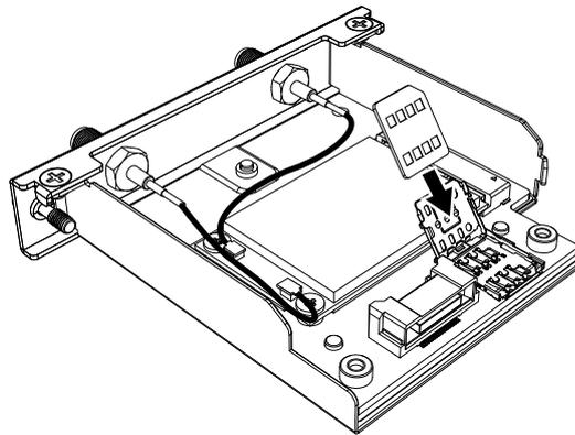
7. カバーを閉じ、矢印の方向にスライドさせてロックします。
