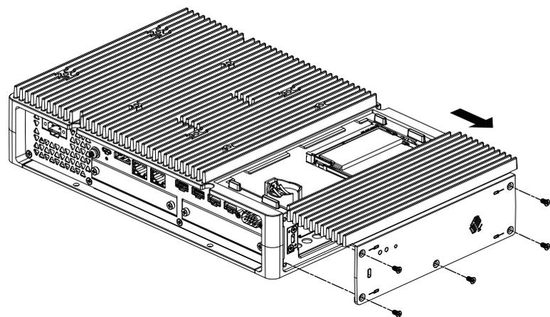
4. M.2 SSD が搭載されている場合、ファンキットを取り付ける前にヒートシンクとヒートシンクパッド (上用) を取り外します。M.2 SSD のヒートシンクとヒートシンクパッドについては、M.2 SSD の取り付けを参照してください。
