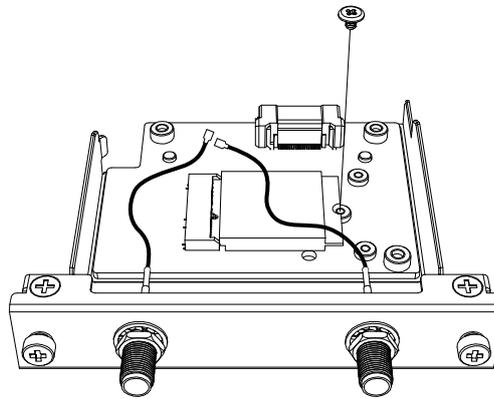
4. 以下の図のように、アンテナケーブルコネクタをカード上のコネクタにしっかりと差し込みます。インターフェイスを上から見て、左側のケーブルコネクタをコネクタ 1 に、右側のケーブルコネクタをコネクタ 2 に差し込みます。
