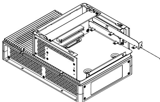
6. PCI/PCIe カードを挿入し、手順 5 で取り外したネジでカードを固定します。
