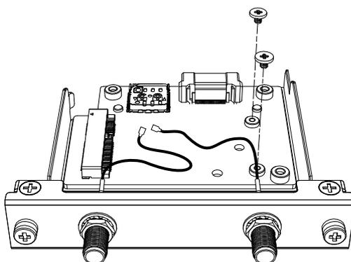
2. 4G mini PCIe カードをスロットに接続します。
