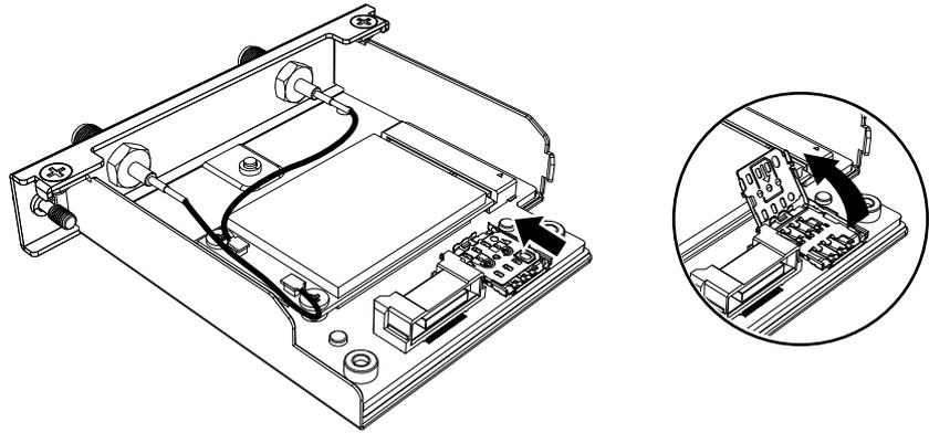
6. SIM カードをスロットに挿入します。
