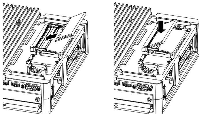
5. メンテナンスハッチカバーを取り付け、ネジを締めます。
