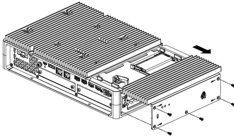
4. HDD または SSD をスロットに挿入します。
