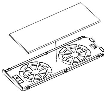
6. ファンフィルタートレイを再度挿入し、ネジを締めます。
