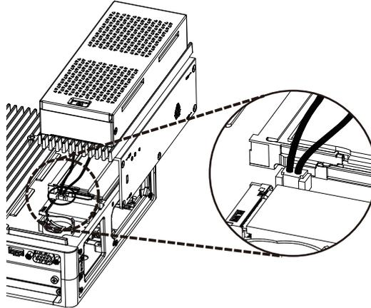
6. 手順 3 で取り外したネジでファンキットを固定します。
