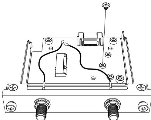
2. 以下の図のように WiFi/Bluetooth カードを斜めに挿入し、上から押し込みます。
