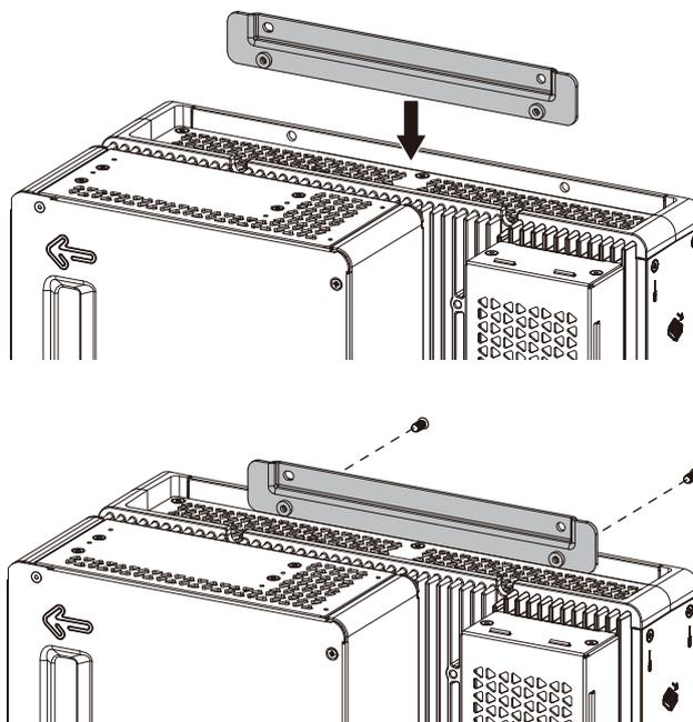
2. Montez le produit au panneau ou au mur avec les vis M4 (4 pièces).
