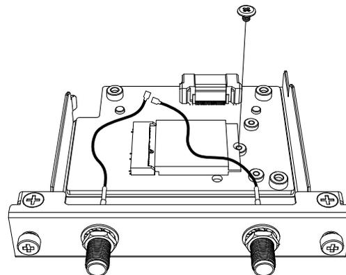
4. Comme illustré ci-dessous, branchez le câble de l'antenne dans le connecteur sur la carte. À partir du dessus de l'interface, branchez le connecteur de câble au côté gauche au connecteur 1 et le connecteur de câble au côté droit au connecteur 2.
