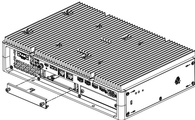
4. Avec le côté étiqueté 'UP' orienté vers le haut, insérez l'interface optionnelle dans le Box Module et serrez les vis.
