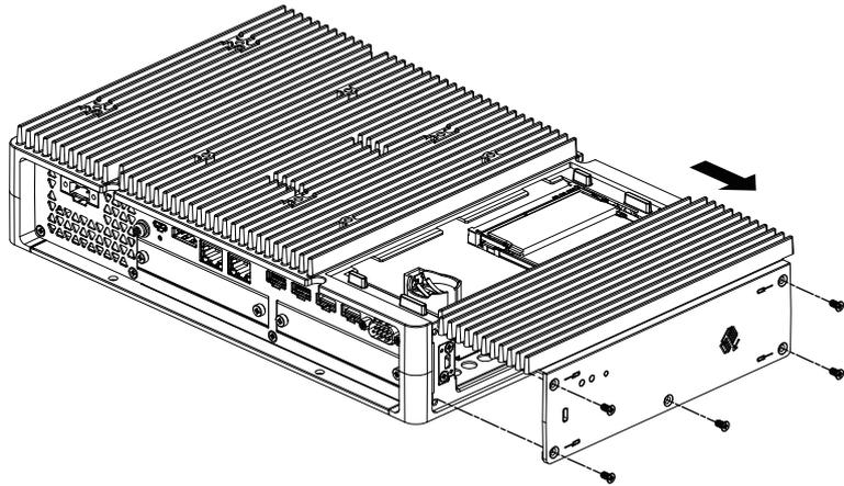
4. Lorsque le produit est équipé d'une carte M.2 SSD, retirez le puits de chaleur et le protecteur de puits de chaleur (haut) avant d'installer le kit ventilateur. Pour plus d'informations sur le puits de chaleur et le protecteur de puits de chaleur pour la carte M.2 SSD, voir [Installation de la carte M.2 SSD](#).
