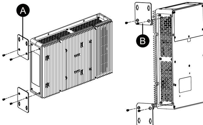
3. Montez le produit au panneau ou au mur avec les vis M4 (4 pièces).
