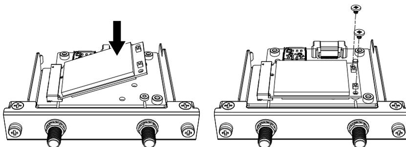
4. Comme illustré ci-dessous, branchez le câble de l'antenne dans le connecteur sur la carte mini PCIe 4G. À partir du dessus de l'interface, branchez le connecteur de câble au côté gauche au connecteur 1 et le connecteur de câble au côté droit au connecteur 2.
