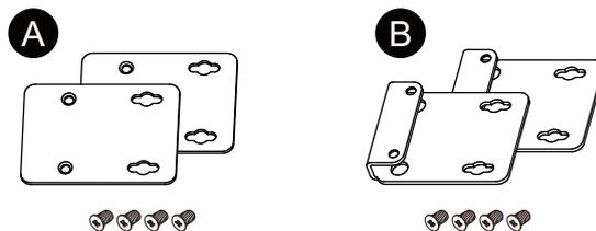
2. Retirez les vis fixées au produit (4 pièces), puis utilisez ces vis pour fixer l'adaptateur de montage book au produit. Lors de la fixation au dessus du produit, fixez l'adaptateur de montage book B de sorte que la pièce en saillie est orientée vers le produit.
