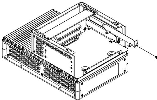
6. Insérez la carte PCI/PCIe et serrez la carte avec la vis retirée à l'étape 5.
