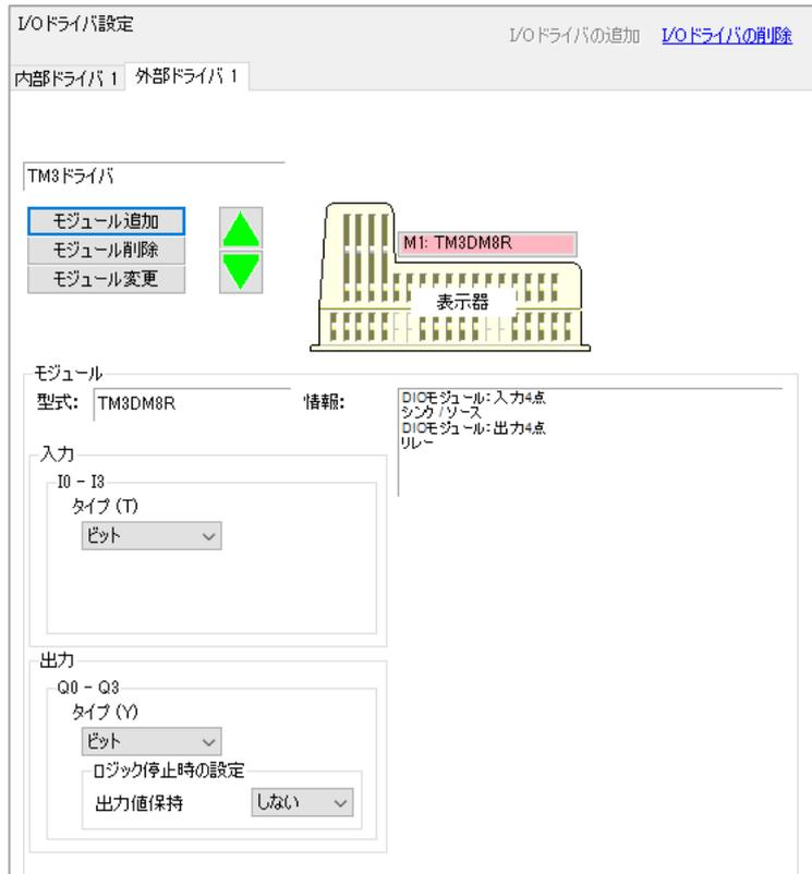
5. [モジュール追加] をクリックしてモジュールを追加します。TM3 モジュールを 3 台以上接続する場合は、送信モジュール (TM3XTRA1) を選択し [OK] を押してください。
