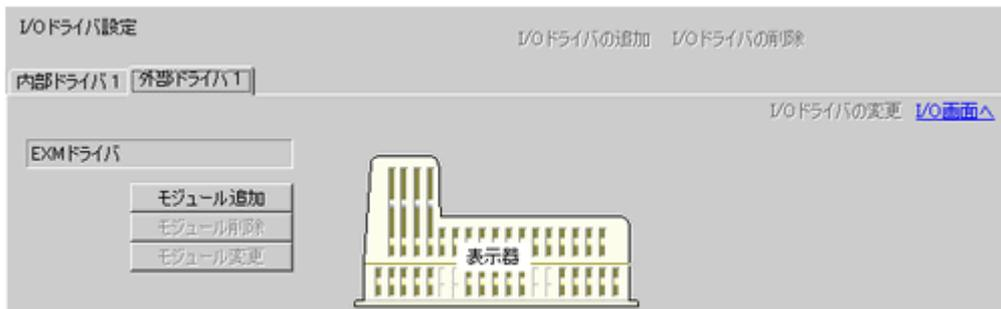
3. [モジュール追加] をクリックすると、[モジュール詳細設定] ダイアログボックスが表示され、モジュールの型式を指定して [OK] をクリックします。
