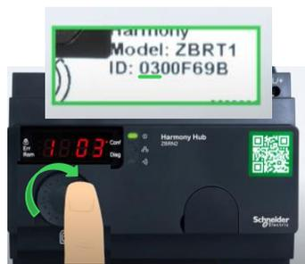
ジョグダイヤルボタンを押しボタンのIDの**最初の2桁**に合わせます。
