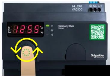
サブネットマスク1項目が点滅表示されるので、設定するアドレスにするまでジョグダイヤルを回し、決定したらジョグダイヤルボタンを1度押します。
