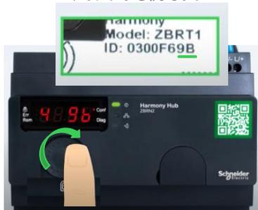
ジョグダイヤルボタンを押しボタンのIDの最後の2桁に合わせます。
