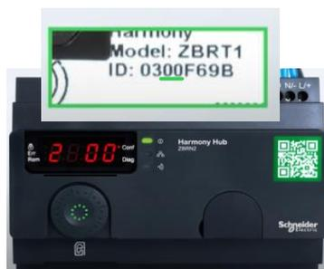
ジョグダイヤルボタンを押しボタンのIDの次の2桁に合わせます。
