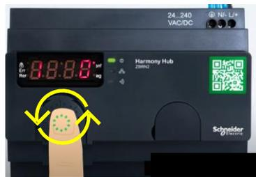
ゲートウェイアドレス1項目が点滅表示されるので、設定するアドレスにするまでジョグダイヤルを回し、決定したらジョグダイヤルボタンを1度押します。
