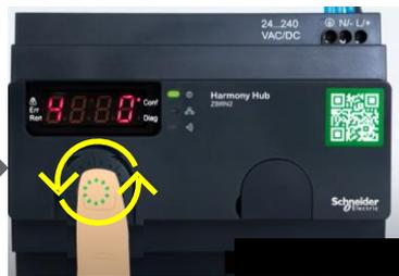
同様にゲートウェイアドレス4項目までジョグダイヤルとジョグダイヤルボタンで設定し、決定したらジョグダイヤルボタンを1度押します。
