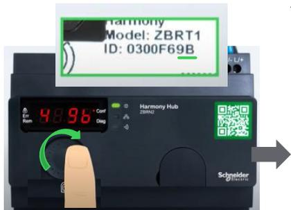
ジョグダイヤルボタンを押しボタンのIDの**最後の2桁**に合わせます。
