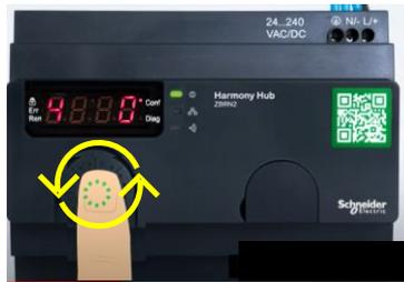
同様にサブネットマスク4項目までジョグダイヤルとジョグダイヤルボタンで設定し、決定したらジョグダイヤルボタンを1度押します。
