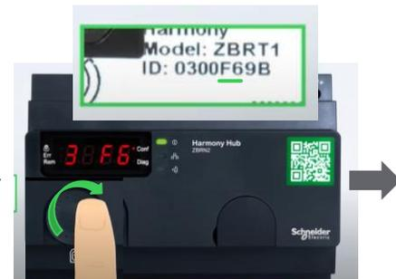
ジョグダイヤルボタンを押しボタンのIDの**次の2桁**に合わせます。
