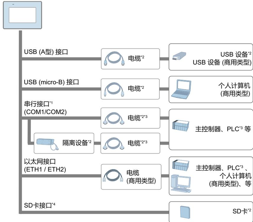
\*1 要将它用作隔离端口，需要隔离设备。要使用 RS-232C 隔离设备，请将串口的 #9 引脚设置为 VCC。
