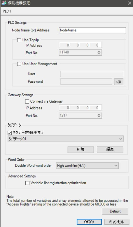
個別機器設定 dialog box のスクリーンショット。タイトルは「個別機器設定」で、内容は「PLC1」の「PLC Settings」セクションに属する。設定項目には「Node Name (or) Address」(NodeName)、TCP/IP 設定 (Use Tcp/Ip)、ユーザー管理 (Use User Management)、ゲートウェイ設定 (Gateway Settings)、タグデータ (Tag Data)、単語順序 (Word Order)、および高度な設定 (Advanced Settings) がある。ボタンの「新規」や「編集」も表示されている。
