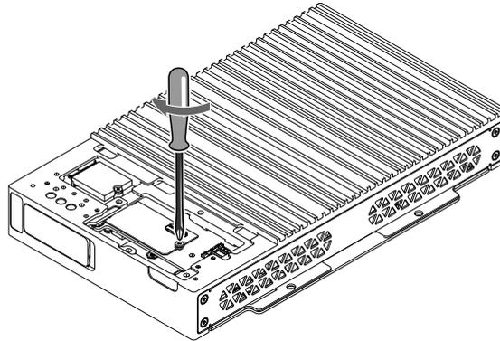
8. Setzen Sie die Ethernet-Modulhalterung auf das Gerät.
