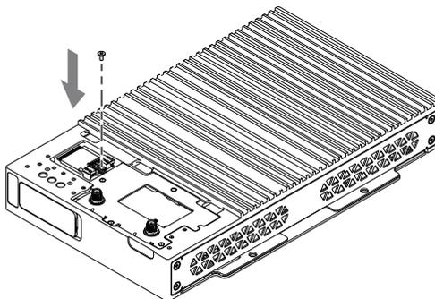
8. Befestigen Sie die WiFi/Bluetooth-Modulhalterung am Produkt und ziehen Sie sie mit M3-Schrauben fest.
