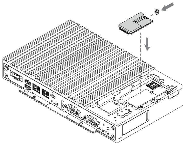
7. Setzen Sie die RS-232C M.2-Karte in den Steckplatz am Produkt ein.
