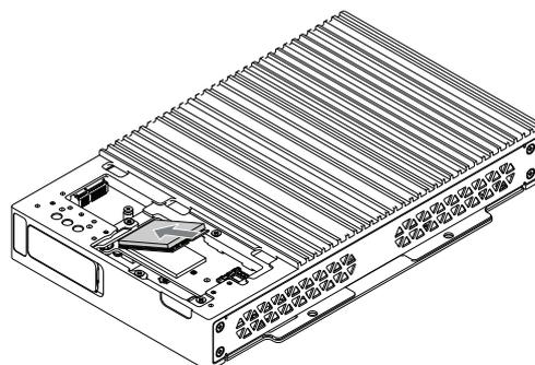
8. Schieben Sie die 4G M.2-Karte von oben hinein und sichern Sie sie mit der M.2 Schraube.
