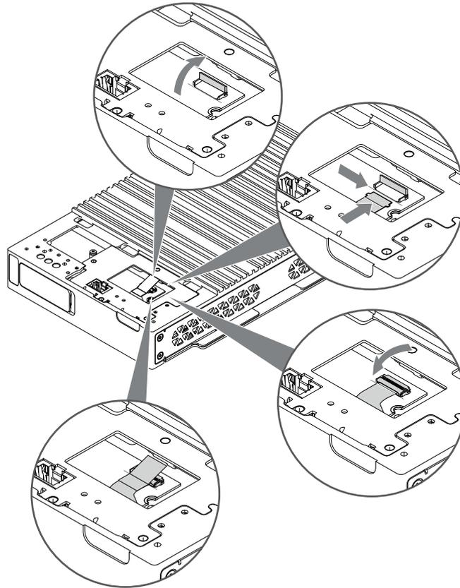
10. Befestigen Sie die Ethernet-Modulhalterung mit M3-Schrauben am Gerät.
