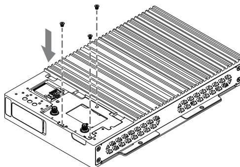
9. Setzen Sie die Abdeckung der optionalen Schnittstelle auf das Box-Modul.
