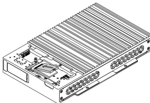
10. Sichern Sie die M.2 SSD-Karte mit der M.2-Schraube.
