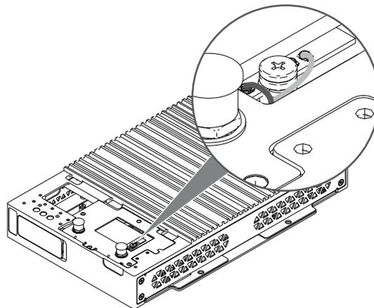
13. Befestigen Sie die 4G-Modulhalterung am Produkt und ziehen Sie sie mit M3-Schrauben fest.
