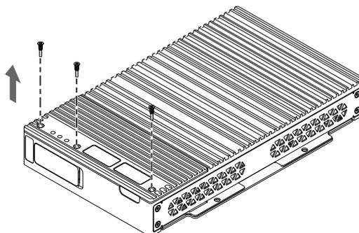
5. Entfernen Sie die Abdeckung der optionalen Schnittstelle.
