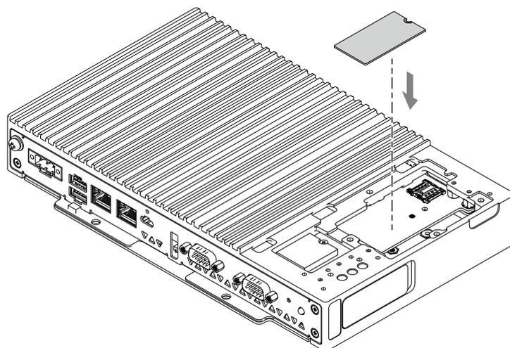
6. Setzen Sie die M.2-Schraube in den Steckplatz der RS-422/485 M.2-Karte ein.
