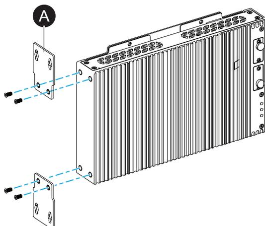
3. Installieren Sie das Produkt mit M4-Schrauben (4 Stück) an der Platte oder Wand.
