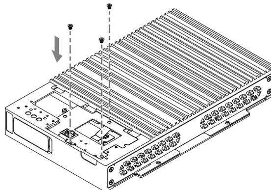
11. Setzen Sie die Abdeckung der optionalen Schnittstelle auf das Box-Modul.
