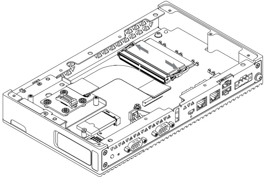
5. Entfernen Sie das DIMM.
