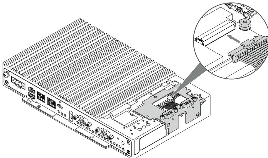
10. Befestigen Sie die RS-422/485-Modulhalterung am Produkt und ziehen Sie sie mit M3-Schrauben fest.
