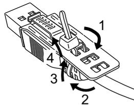
4. Während Sie den Griff an der Klemme gedrückt halten, führen Sie das Kabel von Schritt 3 ganz in die USB-Host-Schnittstelle ein. Stellen Sie sicher, dass sich die Klemmenlasche sicher am USB-Kabel befindet, das an dieses Produkt angeschlossen ist.
