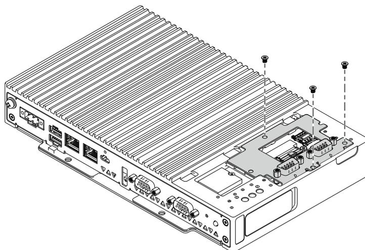
11. Setzen Sie die Abdeckung der optionalen Schnittstelle auf das Box-Modul.
