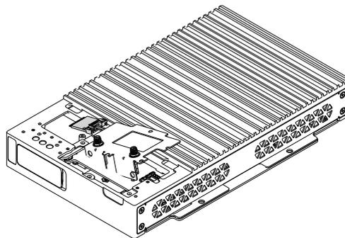
7. Befestigen Sie die Karte mit der in Schritt 5 entfernten Schraube.
