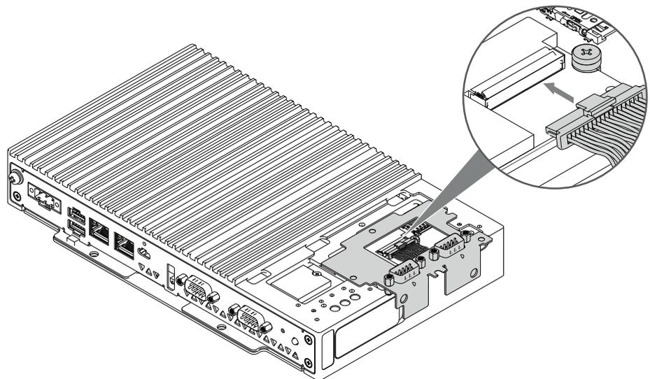
10. Befestigen Sie die RS-232C-Modulhalterung am Produkt und ziehen Sie sie mit M3-Schrauben fest.
