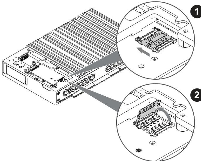
10. Setzen Sie die SIM-Karte in den Steckplatz ein, schließen Sie die Abdeckung und schieben Sie sie in Pfeilrichtung, um sie zu verriegeln.
