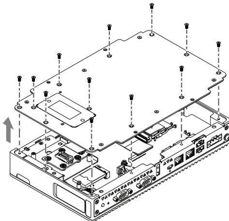
4. Entfernen Sie die Schraube aus dem Installationsbereich der M.2 SSD-Karte am Produkt.
