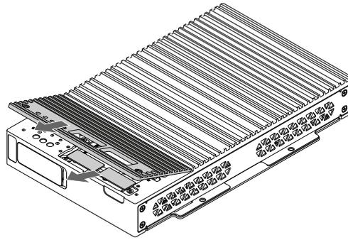
6. Ziehen Sie die Schutzfolie von der Oberseite des Kühlkörper-Pads ab.
