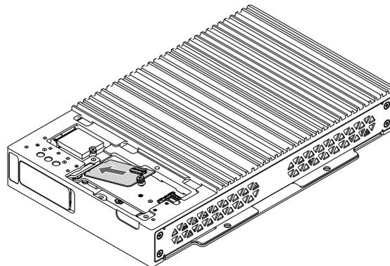
7. Drücken Sie die Ethernet M.2-Karte nach unten und ziehen Sie sie mit der M.2-Schraube fest.
