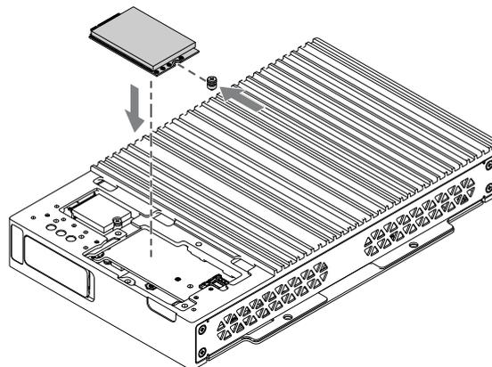
7. Setzen Sie die 4G M.2-Karte in den Steckplatz am Produkt ein.
