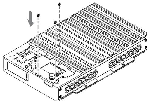
14. Setzen Sie die Abdeckung der optionalen Schnittstelle auf das Box-Modul.
