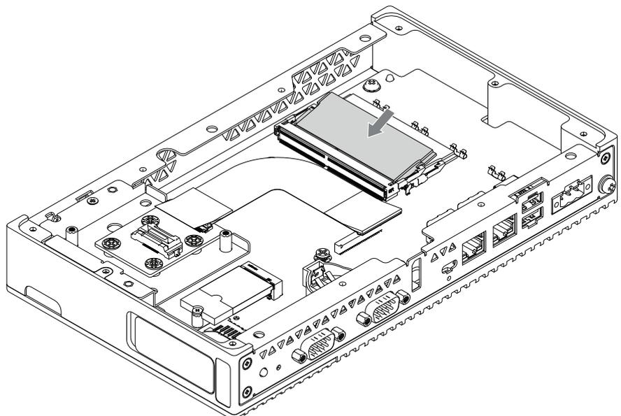
7. Schieben Sie das DIMM auf das Gerät, und das DIMM wird verriegelt.
