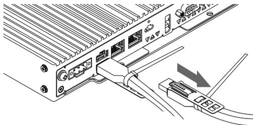
2. Lösen Sie den Kabelbinder der USB-Klemme in der unteren Buchse.
