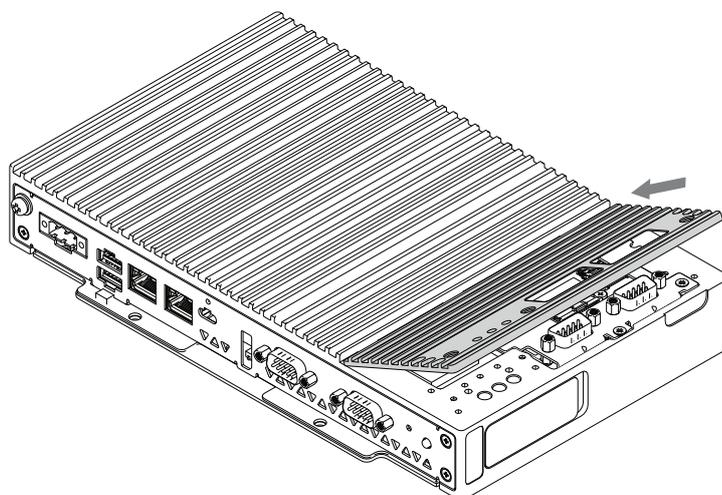
12. Befestigen Sie die Abdeckung der optionalen Schnittstelle mit den Schrauben am Box-Modul.
