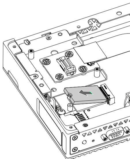
6. Setzen Sie die M.2 SSD-Karte diagonal ein, und drücken Sie dann von oben nach unten.
