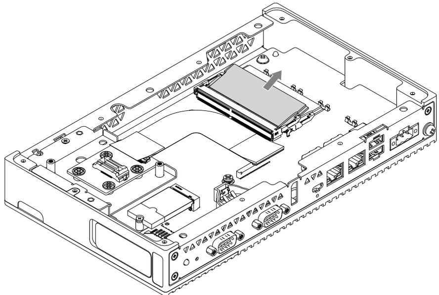
6. Setzen Sie das DIMM in das Gerät ein.
