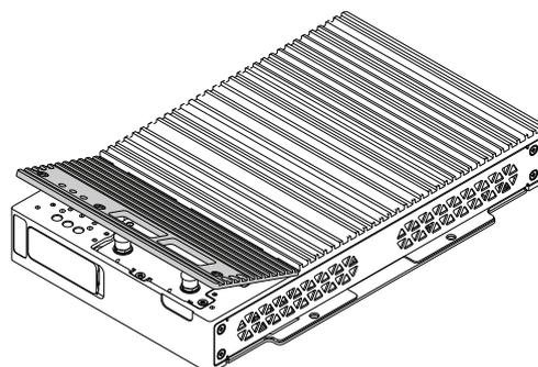
15. Befestigen Sie die Abdeckung der optionalen Schnittstelle mit den Schrauben am Box-Modul.
