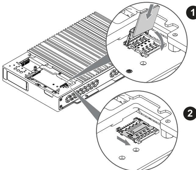
11. Setzen Sie die 4G-Modulhalterung ein.
