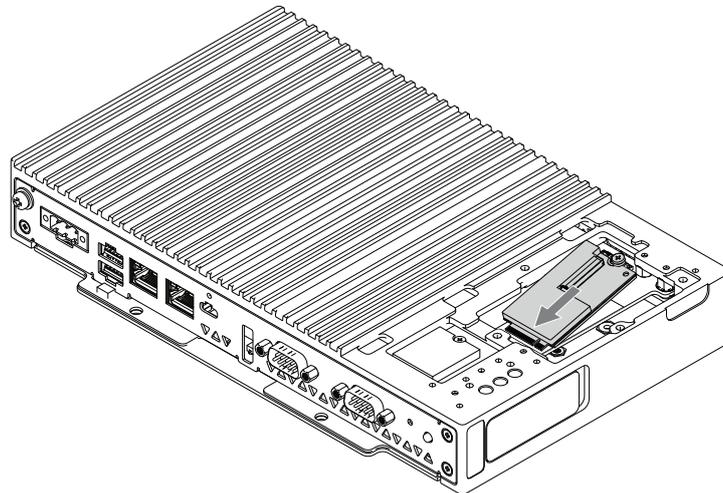
8. Schieben Sie die RS-422/485 M.2-Karte ein und ziehen Sie sie mit der M.2-Schraube fest.
