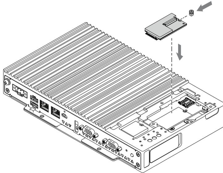
7. Stecken Sie die RS-422/485 M.2-Karte in den Steckplatz am Gerät.
