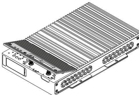
10. Befestigen Sie die Abdeckung der optionalen Schnittstelle mit den Schrauben am Box-Modul.
