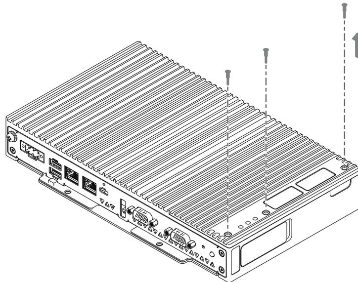
4. Entfernen Sie die Abdeckung der optionalen Schnittstelle.
