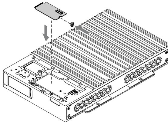
6. Stecken Sie die Ethernet M.2-Karte diagonal in den Steckplatz am Gerät.
