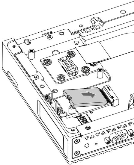
7. Befestigen Sie die M.2 SSD-Karte mit der in Schritt 4 entfernten Schraube.
