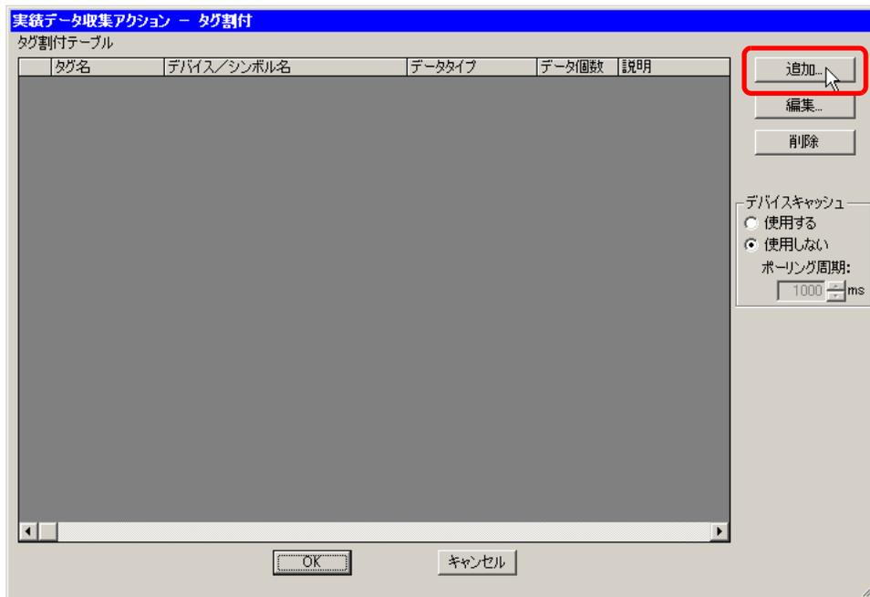
10 データベースに登録されているタグを選択し、そのタグに割り付けるシンボル/デバイスアドレスを設定して、[追加] をクリックします。必要なタグすべてに割り付けが終了したら [閉じる] をクリックします。
