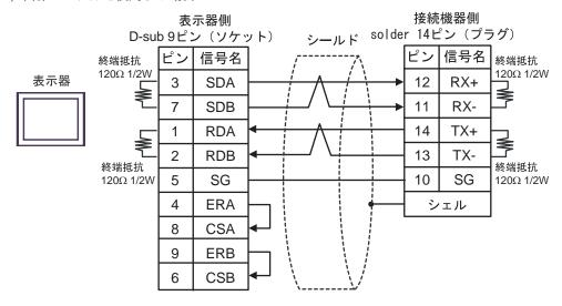
C) (株) デジタル製 オンラインアダプタ (CA4-ADPONL-01) (株) デジタル製 コネクタ端子台変換 アダプタ (CA3-ADPTRM-01) および自作ケーブルを使用する場合
