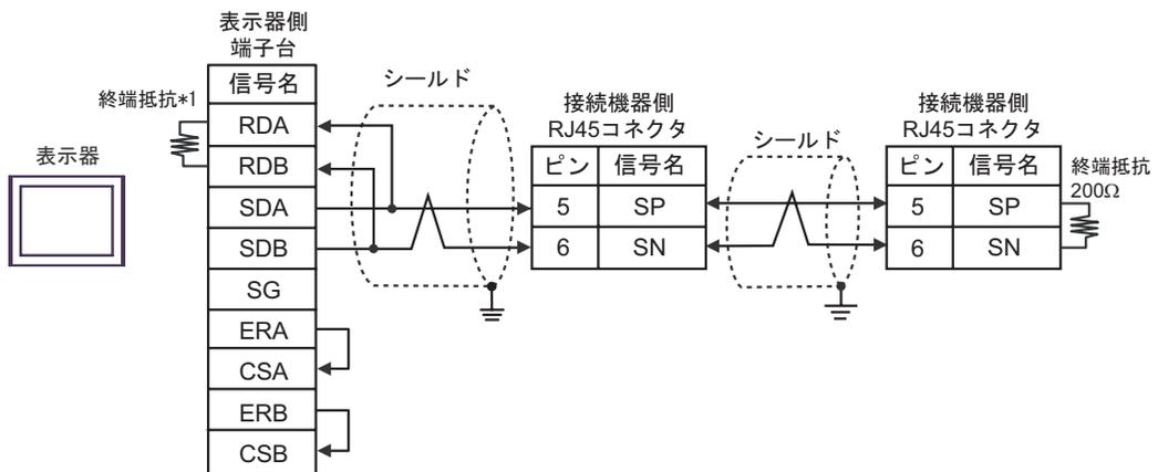
\*1 表示器に内蔵している抵抗を終端抵抗として使用します。表示器背面のディップスイッチを以下のように設定してください。
