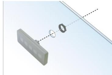
ホールソーで簡単に盤加工ができ、少ない工数で設置できます。また、既存のスイッチ穴を流用することもできます。
