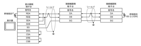
\*1 表示器に内蔵している抵抗を終端抵抗として使用します。表示器背面のディップスイッチを以下のように設定してください。
