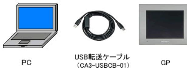
1. USB 転送ケーブル（型式：CA3-USBCB-01）を接続します。
