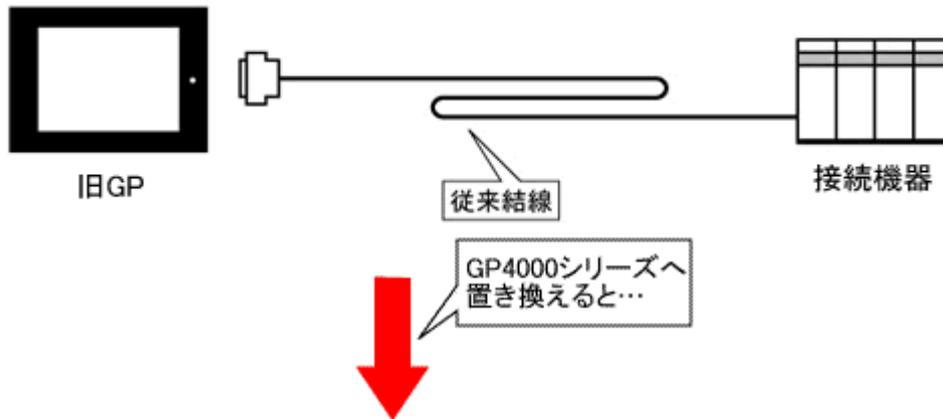
GP-4500 シリーズへ置き換え後のシステム構成 (COM1 へ接続)
