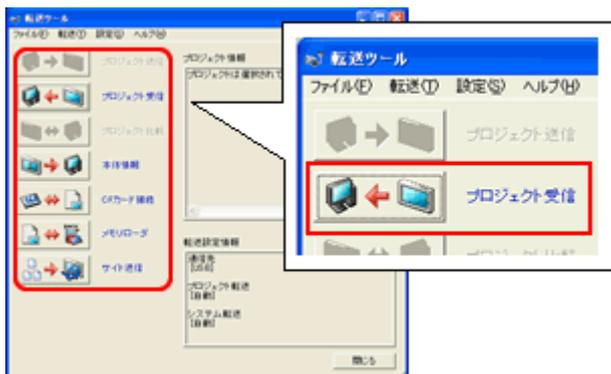
(4) [プロジェクト受信]をクリックします。次のダイアログボックスが表示されるので、受信するデータの保存場所とプロジェクトファイル名を設定し、[保存(S)]をクリックすると転送が開始されます。
