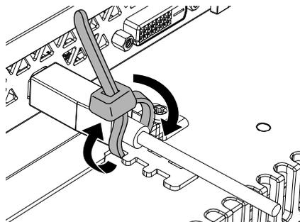
**NOTE:** Vous pouvez remplacer l'attache par une attache disponible dans le commerce d'une largeur de 4,8 mm (0,19 in) et d'une épaisseur de 1,3 mm (0,05 in).
