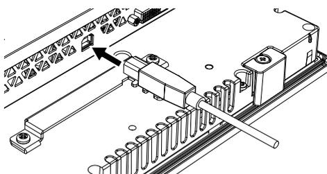
3. Faites pivoter l'attache comme illustré pour fixer le câble USB au support et pour que le câble USB puisse passer par le centre de la boucle de l'attache.
