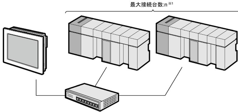
※1 UDP 接続は最大 32 台、TCP 接続は最大 16 台接続できます。
