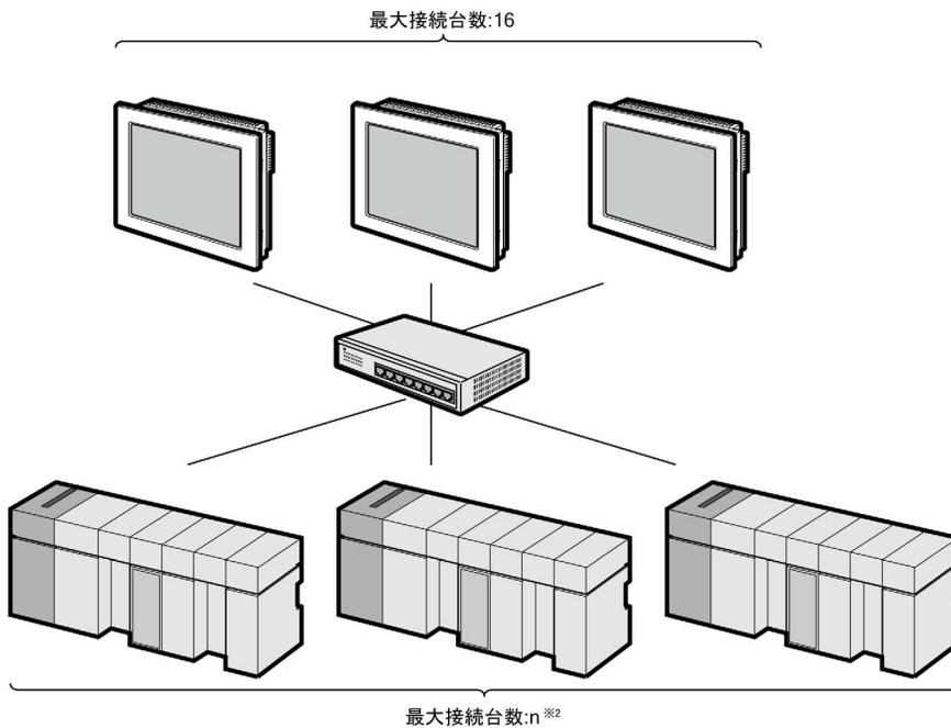
※2 UDP 接続は最大 32 台、TCP 接続は最大 16 台接続できます。
