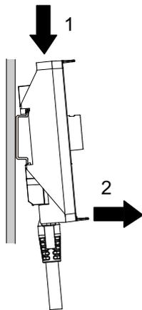
3. Halten Sie die Taste oben am Verbindungskabel gedrückt, und ziehen Sie das Verbindungskabel gerade heraus.
