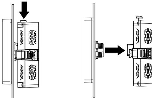
2. Entfernen Sie die Mutter und das Anzeigemodul von der Platte.
