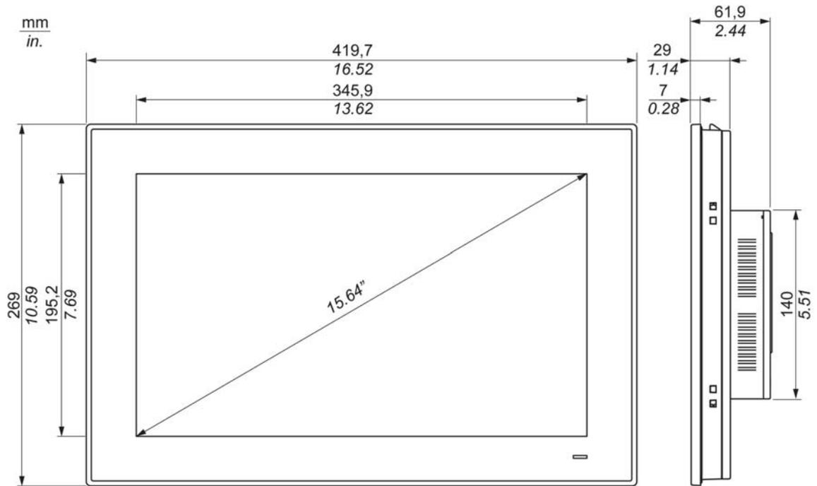
下図に AC 電源モジュール (PFXZPSPUAC2) と拡張キット (PFXZPSADSSD2) のある場合の寸法を示します。
