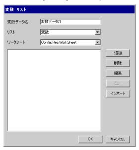
2 [追加]をクリックして[変数]ダイアログボックスを表示します。
