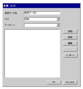
**5** [インポート]をクリックし、手順 2. でエクスポートした CSV ファイルと IEC ファイルをインポートします。
