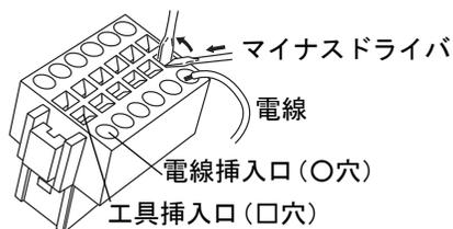
4. マイナスドライバを工具挿入口（□穴）から抜き取ります。電線挿入口（○穴）は閉口し電線が固定されます。電線を抜く場合は、抜きたい電線に対応した工具挿入口（□穴）にマイナスドライバを手順(1)(2)に従って差し込んだ状態で抜いてください。
