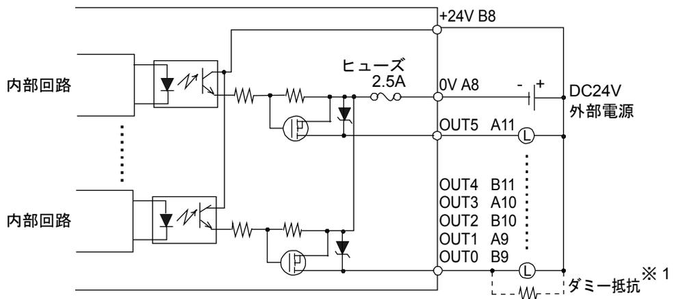
※1 (例) 出力 DC24V、50mA 時では、出力遅延時間 (OFF → ON) は 1.5 $\mu$ s です。応答性を必要とし、負荷が軽い場合は、外部にダミー抵抗を設けて電流を増やしてください
