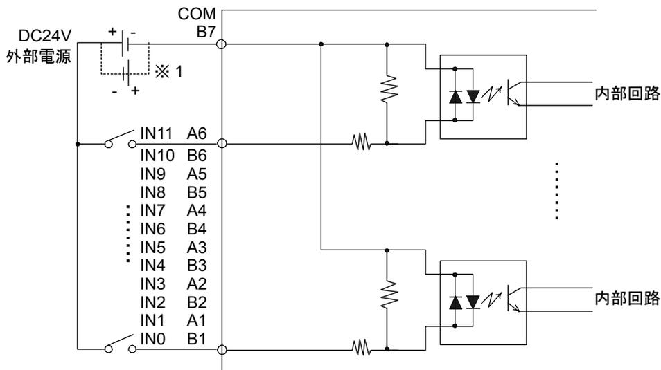
※ 1 点線部分はシンク出力タイプ機器との結線図です。
