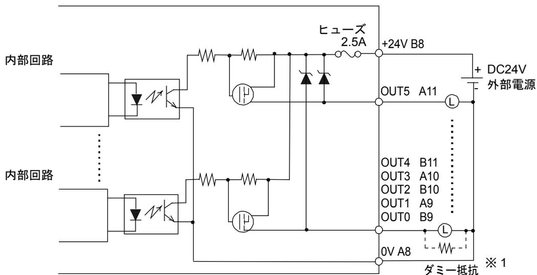
※1 (例) 出力 DC24V、50mA 時では、出力遅延時間 (ON → OFF) は 1.5 $\mu$ s です。応答性を必要とし、負荷が軽い場合は、外部にダミー抵抗を設けて電流を増やしてください。
