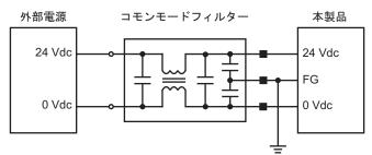
■は専用ケーブルとコモンモードフィルターの接続部
