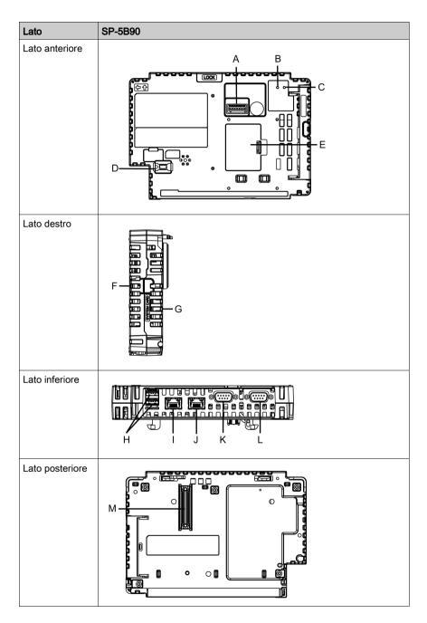
A: Interfaccia Uscita ausiliaria/Uscita altoparlante (AUX)
