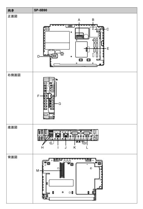
A: 補助出力/音声出力インターフェイス (AUX)
