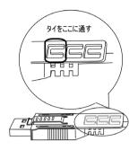
3 図のように、タイをクリップの穴に通します。次に、USB ケーブルがタイの輪の中を通るようにタイを回してヘッドに少し通すと、クリップが USB ケーブルに固定されます。
