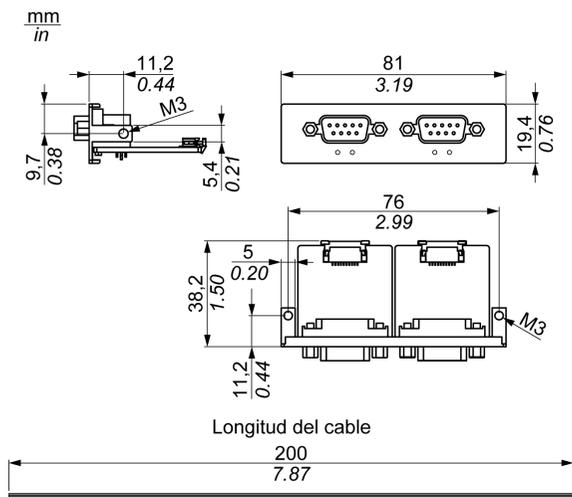
En la siguiente figura se muestran las dimensiones de las 4 interfaces RS-232, RS-422/485:
