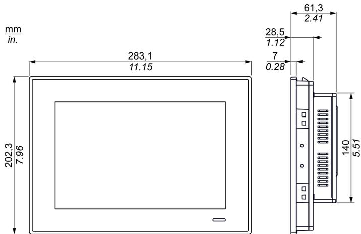
En la figura se muestran las dimensiones con el módulo de alimentación de CA (PFXZPSUAC2) y el kit de ampliación (PFXZPSADSSD2):
