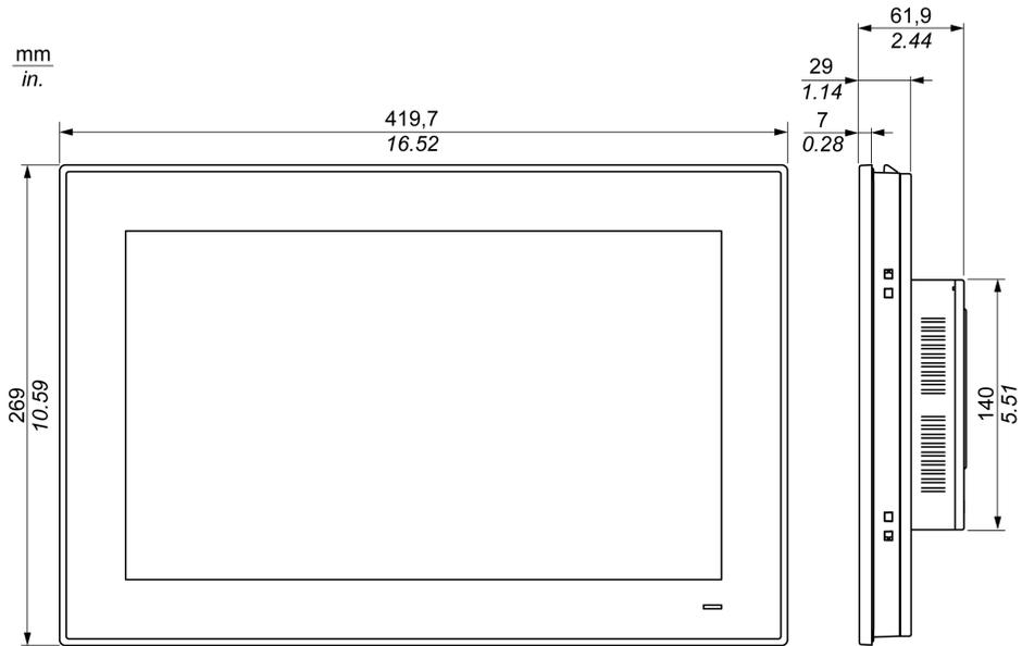
En la figura se muestran las dimensiones con el módulo de alimentación de CA (PFXZPSPUAC2) y el kit de ampliación (PFXZPSADSSD2):
