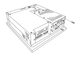
HDDユニットのネジ(2カ所)を外し、 ブランクパネルを取り外します。
