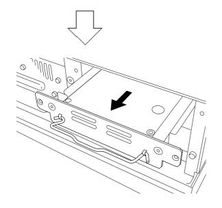
HDDユニットの取手を持ち、新たに 組み込む HDD ユニットをガイド レールに沿うように PL に挿入し、 コネクタが完全に接続されるよう 差し込みます。
