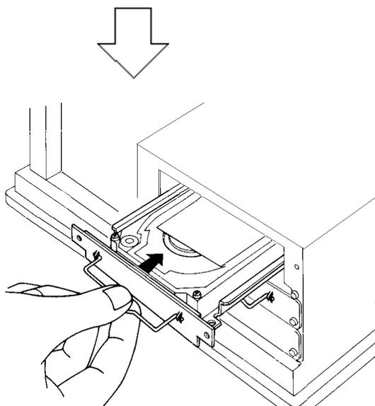
HDD ユニットの取手を持ち、新たに組み込む HDD ユニットのガイドレールに沿うように PL に挿入し、コネクタが完全に接続されるよう差し込みます。
