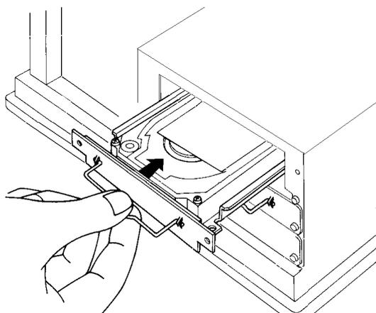
HDD ユニットの取手を持ち、新たに組み込む HDD ユニットのガイドレールに沿うように PL に挿入し、コネクタが完全に接続されるよう差し込みます。
