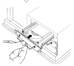
HDDユニットの取手を持ち、新たに 組み込む HDD ユニットをガイド レールに沿うように PL に挿入し、 コネクタが完全に接続されるよう 差し込みます。
