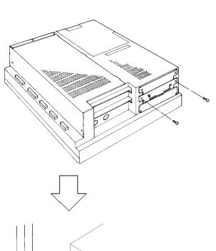
HDDユニットのネジ(2カ所)を外し、 ブランクパネルを取り外します。
