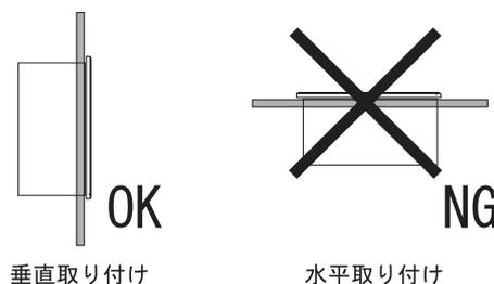
傾けて取り付ける場合は、本機内部での熱ごもりを最小限にするために垂直から前後30°以内で取り付けてください。
