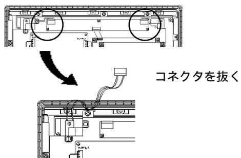
LCDユニットからバックライトを外します。
