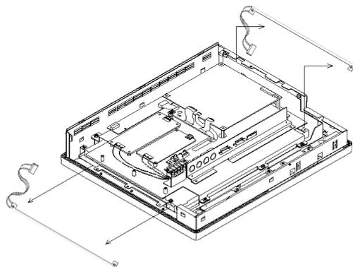
交換用バックライトをLCDユニットに元のように取り付け、4カ所をネジ止めします。
