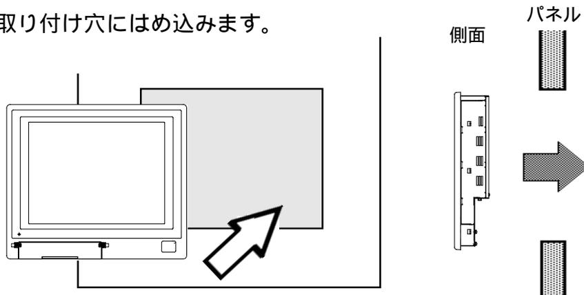
パネルの裏側を取り付け金具で固定します。
