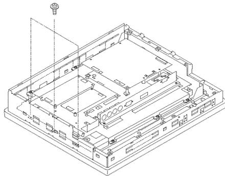
バックライトの固定ネジ4カ所をゆるめます。
