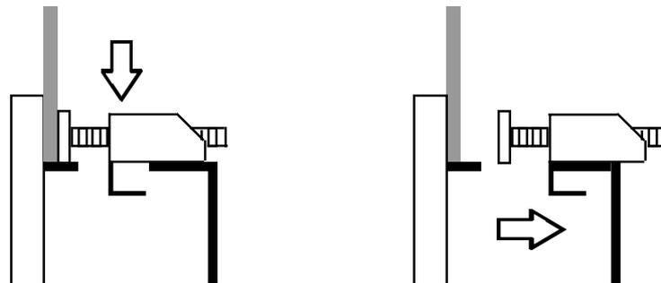
取り付け金具をドライバーで締めつけてFPを固定します。防水性の確保のため、トルクドライバーで締めつけトルクを0.5 ~ 0.6N・mの範囲にしてください。
