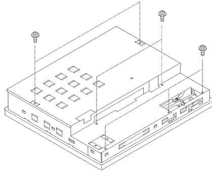
内部3カ所のネジをドライバーでゆるめ、サイドブラケットを取り外します。
