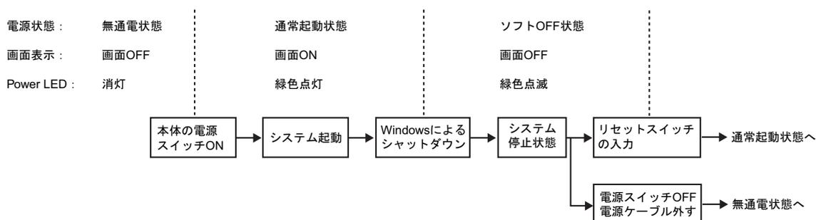
※1 ソフト OFF 状態とは、システムの起動のために必要な回路にのみ電源が供給されている状態のことを指し、Windows<sup>®</sup> によるシャットダウンを行った後の状態です。Windows<sup>®</sup> で設定するシステムスタンバイとは異なります。
