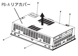
PS-Aを水平に置きリアカバーの ネジ(5ヶ所)を外します。
