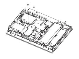
HDD ユニットを左図のように配置 し、ネジ(4カ所)で固定します。 締め付けトルクは、 $0.5 \sim 0.6N \cdot m$  です。
