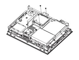
HDD ユニットを左図のように配置 し、ネジ(4カ所)で固定します。 締め付けトルクは、 $0.5 \sim 0.6N \cdot m$  です。
