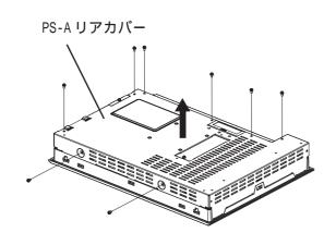
PS-Aを水平に置きリアカバーのネジ (8ヶ所)を外します。
