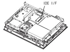
HDD ユニットのケーブルを左図 の IDE I/F に完全に接続される ように差し込みます。
