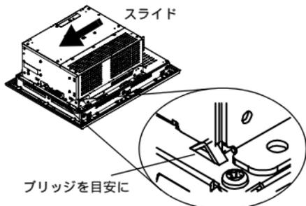
(5) コントロールボックスを下側から持ち上げ、コントロールボックス取り付け金具の長穴からフロントモジュールのツメを抜いてコントロールボックスを取り外します。
