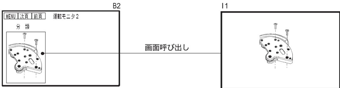
外部データのビットマップイメージデータをイメージ画面に登録することができます。ビットマップの利用により、よりリアルなイメージ図や指示図を作画時や運転時に画面に表示することができます。
