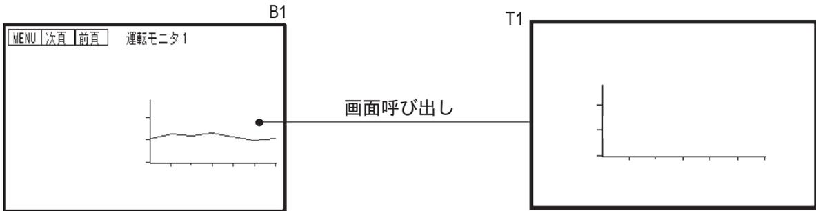
T1で作画した折れ線グラフのグラフ軸やグラフ表示用の設定を作画時に画面呼出でベース画面に呼び出し利用します。
