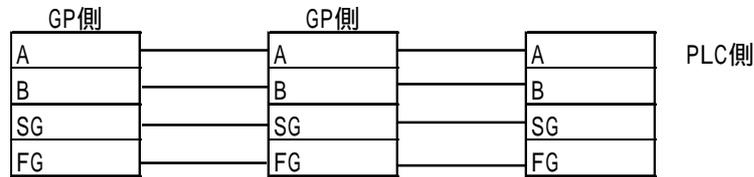
**強制** ・ PLC本体のFG端子はD種接地を行ってください。
