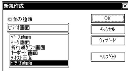
ビデオ画面を選択したときのみウィザードボタンがクリック有効になります。ウィザードボタンをクリックするとビデオ設定用のウィザードダイアログが開きます。
