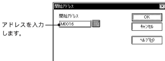
グローバルクロスリファレンスのアドレスマップ表示では、ビット単位で表示するか、ワード単位で表示するかを切り替える際、マップの表示開始アドレスを設定します。
