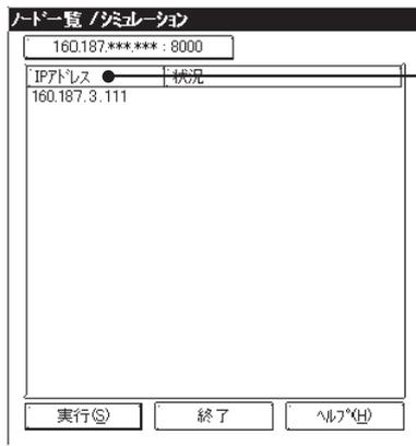
表示されている GP を選択し、実行ボタンをクリックするとノード一覧ダイアログは消去され、シミュレーションウィンドウが表示されます。
