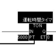
同様にオンディレイタイマをベース画面上にドラッグ&ドロップします。オンディレイタイマはベース画面上で設定値表示器として扱われます。
