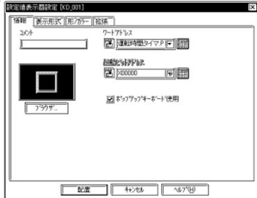
表示された [ 設定値表示器設定 ] ダイアログボックスで、[ ポップアップキーボード使用 ] を指定します。続いて [ 配置 ] ボタンをクリックし、画面上に配置します。
