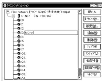
Flex Network ドライバ内の FN-XY08TS に I0 から I7 と Q0 から Q7 が表示されます。I は入力、Q は出力の外部 I/O を指します。今回は I3 をダブルクリックして「センサ」と入力し、[ ENTER ] キーを押します。
