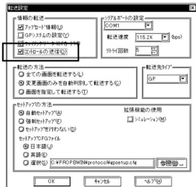
ツールバーの
