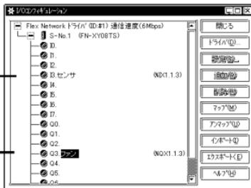
I/O コンフィギュレーションから変数を割り付けます。「センサ」を1つ目のb接点、「ファン」をOR回路のa接点とコイルにドラッグ&ドロップします。
