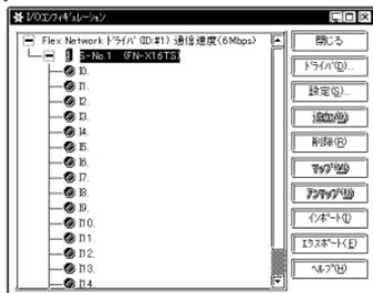
表示された I/O ユニットを選択し、[設定]ボタンをクリックします。
