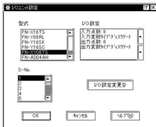
[ 型式 ] から [ FN-XY08TS ] を選択し、[ OK ] ボタンをクリックします。
