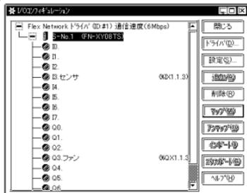
同様に Q3 に「ファン」と名前を付けます。I/O コンフィギュレーションで外部 I/O 端子に割り付けた変数名はロジックプログラム・画面ソフトから外部機器へのアクセスに使用されます。今回の場合、センサからの入力は「センサ」、ファンへの出力は「ファン」という変数名を使用します。
