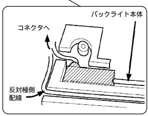
バックライトカバーをはめ込み、止めネジで(各2ヵ所)を締めます。
