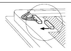
本体のインバータからバックライトのコネクタを外します。
