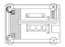
バックライトカバーの止めネジ(各2ヵ 所)をゆるめ、カバーを外します。
