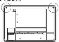
GP の電源を切ります。本体背面のカバー止めネジ(2ヵ所)をドライバでゆるめます。
