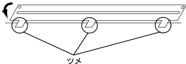
バックライトカバーの各3ヶ所のツメを引っかけるようにかぶせ、止めネジを元どおり締めます。
