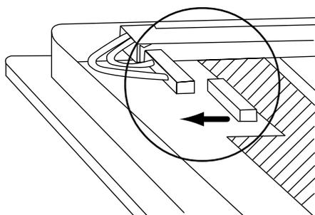
本体のインバータからバックライトのコネクタを外します。
