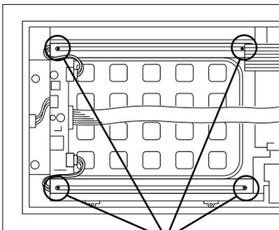
バックライトカバーの止めネジ（各2カ所）をゆるめ、カバーを外します。
