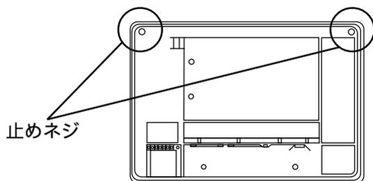
GPの電源を切ります。本体背面のカバー止めネジ(2カ所)をドライバでゆるめます。
