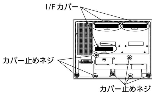
GPの電源を切ります。本体背面にあります3つのI/Fカバーを外します。そしてカバー止めネジ(7カ所)をドライバでゆるめます。
