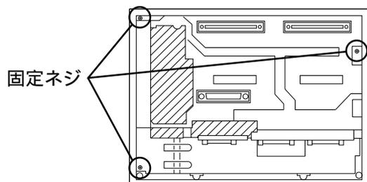
基板シャーシの固定ネジ(3カ所)をゆるめます。
