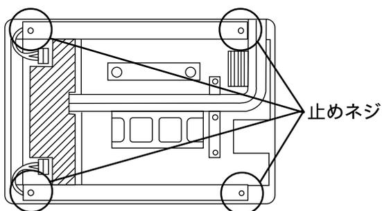
バックライトカバーの止めネジ(各2カ所)をゆるめ、カバーを外します。
