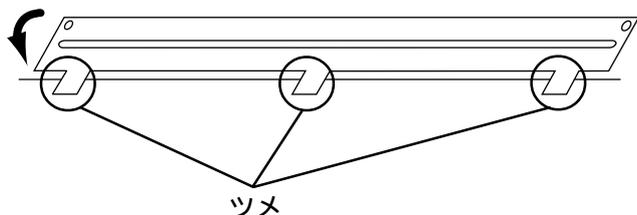
バックライトカバーの各3ヶ所のツメを引っかけるようにかぶせ、止めネジを元どおりに締めます。
