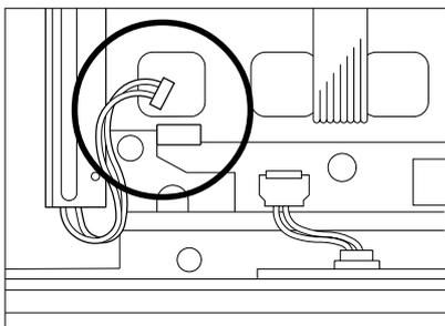
本体のインバータからバックライトのコネクタを外します。
