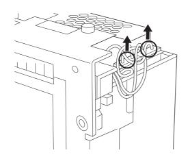
本体のインバータからバックライトのコネクタ(2カ所)を外します。
