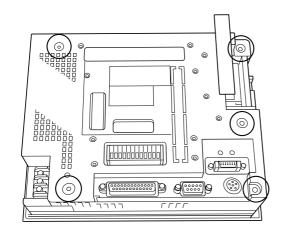
GP/GLC/PS の電源を切ります。CF カードカバーを開け、本体背面に ありますネジ(5カ所)をドライバ で外します。
