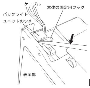
図のようにバックライトユニット 挿入口が上向きになるように本体 を縦におきます。
