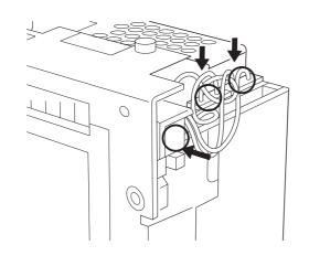
新しいバックライトユニットを差し込みます。バックライトユニットのコネクタを図のように元どおりに差し込みます。
