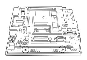
本体上面と底面のネジ(計4カ所) をはずします。(図は底面ですが、 上面にも同じ位置にネジがありま す。)
