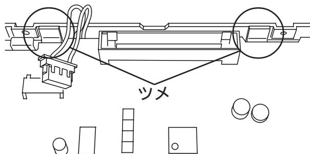
バックライトユニットのツメを指で押し込み、上方向へ押し上げます。
