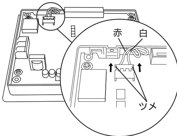
表示モジュールの上部にあるツメ（2カ所）の両方を内部に向けて押し込み、表示モジュールを前面カバーから斜めに浮かせた状態にします。
