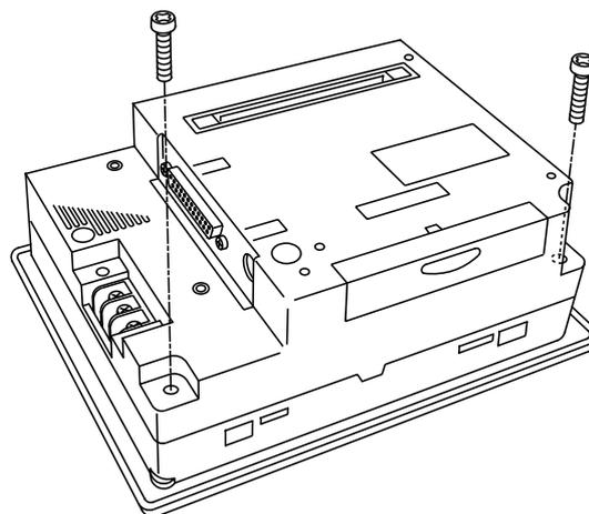
本体上面についているカバー止めネジ（2カ所）をドライバで外します。
