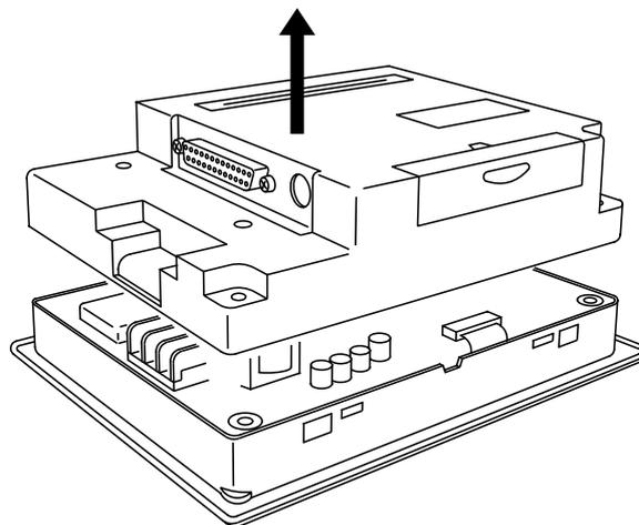
表示モジュールからバックライトユニットのコネクタを外します。コネクタの左右のツメを指でつまみ、上方向へ引っ張ります。
