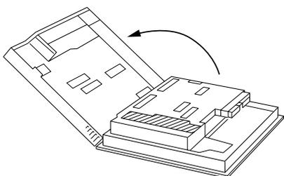
図のように、背面カバーの下部分をゆっくり上方へ開き、外します。
