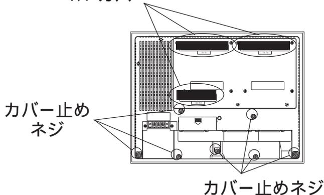
GP/PS の電源を切ります。本体背面にあります3つの I/F カバーを外します。そしてカバー止めネジ(7カ所)をドライバでゆるめます。
