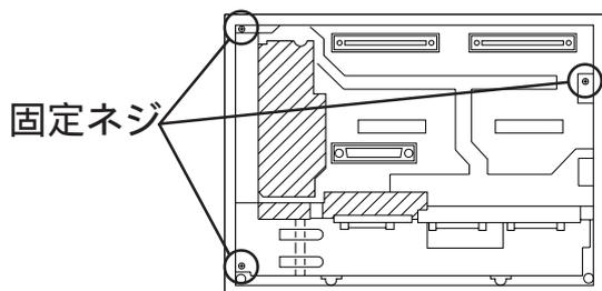
基板シャーシの固定ネジ(3カ所)をゆるめます。
