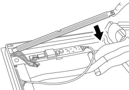
新しいバックライトユニットを と同じ方向にスライドさせながら、はめ込みます。バックライトユニットのネジを締めてから、コネクタを元どおりに差し込みます。
