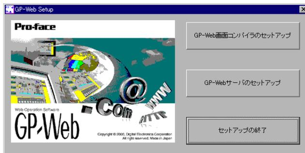
2. GP-Web画面コンパイラをインストールする場合は[GP-Web画面コンパイラのセットアップ]をクリックします。GP-Web Traffic Centerプログラムをインストールする場合は[GP-Webサーバのセットアップ]をクリックします。
