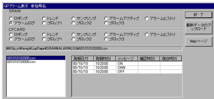
2. [GPアラーム表示]ウィンドウの上部で、表示したいデータの種類の名前をクリックします。SRAMのデータを表示したい場合は[SRAM]にあるデータ種類名、CFカードのデータを表示したい場合は[CFCARD]のデータ種類名をクリックします。左下にCSVファイルの一覧が表示されます。
