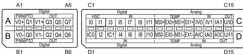
**注記**：コネクタラベル ABCD と本体に刻印されている ABCD を確認の上、配線してください。
