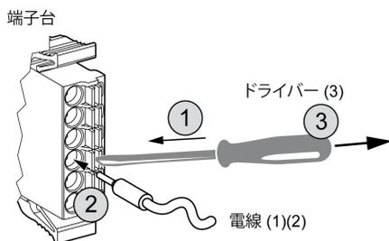
次の手順を使用して、電線を端子台に接続してください。
