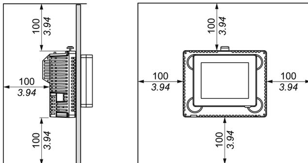
図は、リアモジュールを搭載したパネルを取り付ける方法を示しています。
