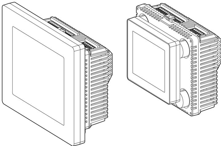
ディスプレイモジュール / リアモジュール分離用ケーブルを用いた DIN レールへのリアモジュールの取り付け
