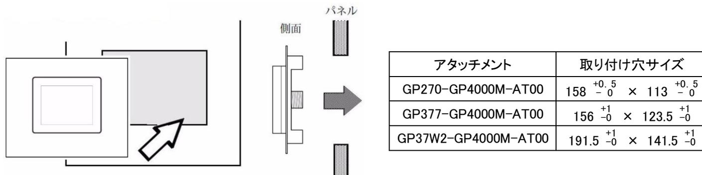
・パネルの裏側を取り付け金具で固定する
