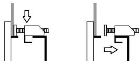
③ 取り付け金具のネジの後ろをドライバーで止めます。防滴効果を得るためのしめつけトルクは 0.5～ 0.6N・m です。
