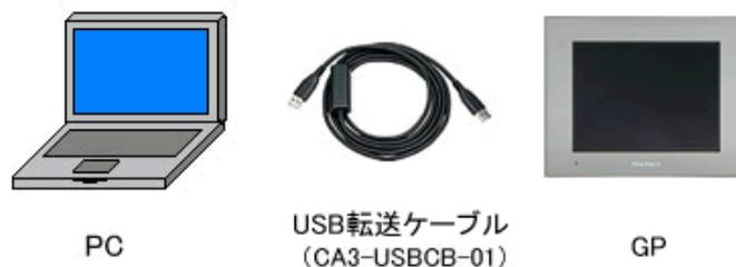
1. GP411XT に USB 転送ケーブルを接続します。USB 転送ケーブルのドライバがインストールされていない場合はダイアログボックスが表示されますので、指示にしたがってインストールしてください。
